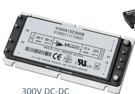
300V DC-DC Converter
