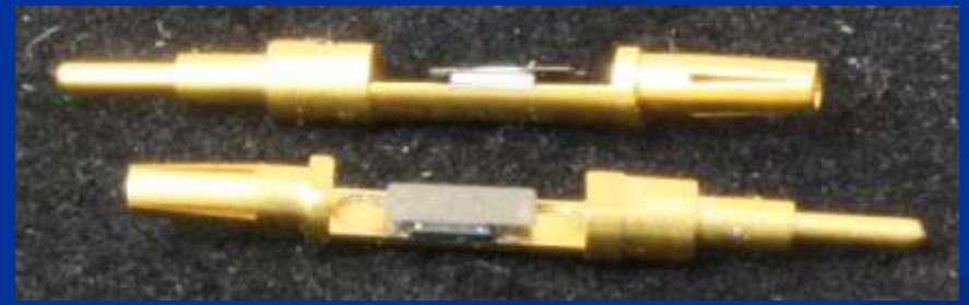
DIE CONTACT ASS'Y WITHOUT ENCAPSULANT
